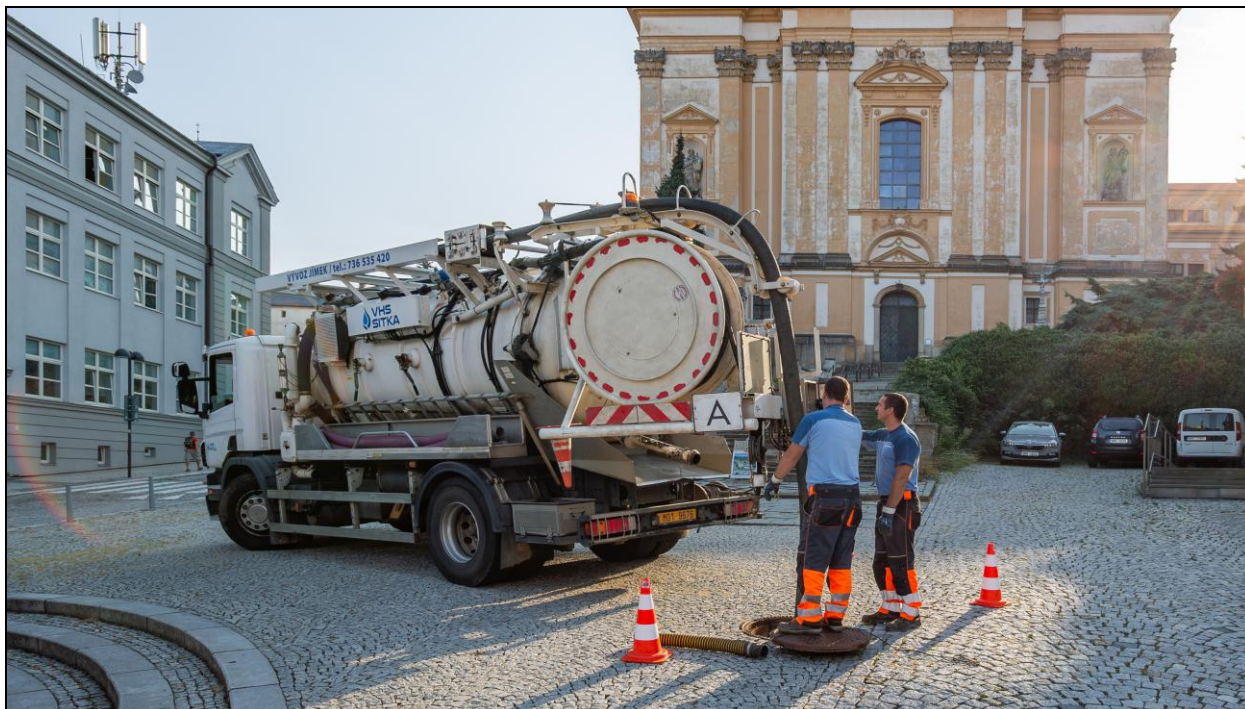
Čištění kanalizace vlastní technikou – kanalizační stroj Kroll na podvozku Scania (Šternberk, léto 2024)
