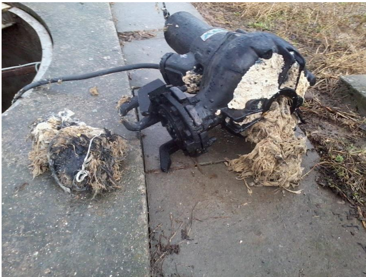
Ucpané čerpadlo na ČOV Mladějovice
